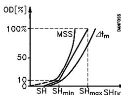
La referencia sigue una curva ya definida. Esta curva esta definida por tres valores: el valor de cierre, el valor mínimo y el valor máximo. Estos tres valores deben seleccionarse de tal forma que la curva este situada entre la curva MSS y la curva de la diferencia de temperaturas medias  $\Delta T_m$  (diferencia de temperatura entre la temperatura del medio a enfriar y la temperatura de evaporación).
