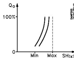
La regulación se basa en la carga del evaporador según la curva MSS (MSS = recalentamiento más bajo permitido). (La referencia del recalentamiento es menor que el punto donde comienza la inestabilidad).
